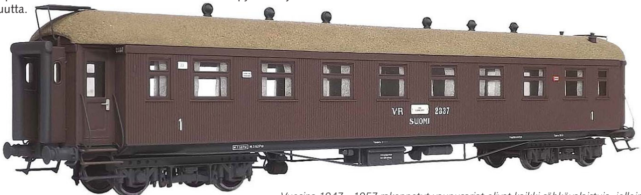
Vuosina 1947—1957 rakennetut vauvusarjat olivat kaikki sähkövalaistuja, jolloin kattokalusteiden määrä on selvästi pienempi kuin kaasuväläistävissä vauvuissa. Ci-sarjan ensimmäisen luokan vauvuissa on ainoastaan kuusi kappaletta torpedotuulettimia.
