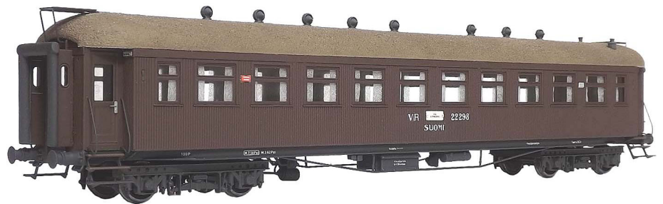
"Perus-Ei" on vuonna 1952 rakennettu päivävaunu. Alkujaan vauvuissa ei ollut kumisia ylimeno- suoja. Olympia-vuonna rakennettua vauvuuta kutsutaan monesti harrastuspiireissä "Olympia-vauvuksi".
