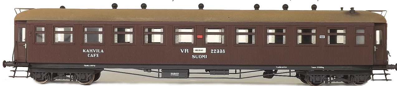
Kahvilaosastolla varustettua vaunua lämmitetään kamiinalla. Tästä merkinä kamiinanpiippu vaunun katolla.
