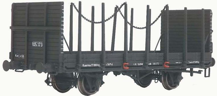
1950-luvun alussa valmistuneessa Hdk-sarjassa oli umpinaiset päädyt ja rullalaakerit.
