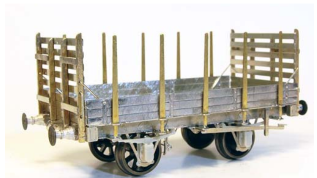
Mp-sarjan tolppavaunut rakennettiin muutostöinä M-sarjan matalalaitaisista soravaunuista.
