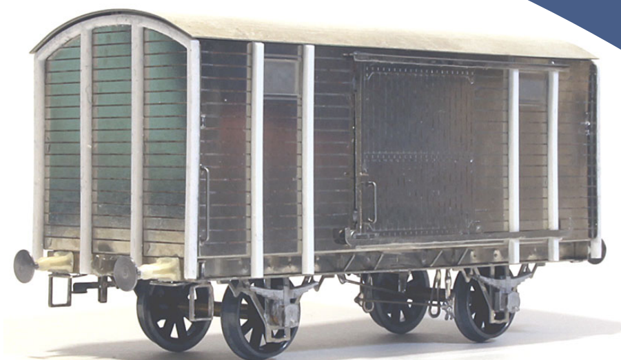
Sivuseinien pystytolpat ovat polystyreenirimoja. Päädyn yhtenäinen kappale on laserilla leikattua muovia. Osat istahdavat seiniin syövytettyihin syvänteisiin pikaliimalla.
