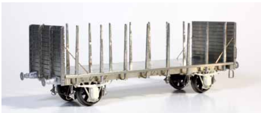
Kaksiakselinen prototyyppimalli, jossa puskimet, laakeripesät ja jarrulaitos eivät vielä vastaa lopullista versiota. Mestari Mallien kaksiakselinen vaunu on muunnosvaunu kolmiakselisesta. Suoraan kaksiakseliseksi rakennetussa K-vaunussa akseliväli oli lyhyempi.
