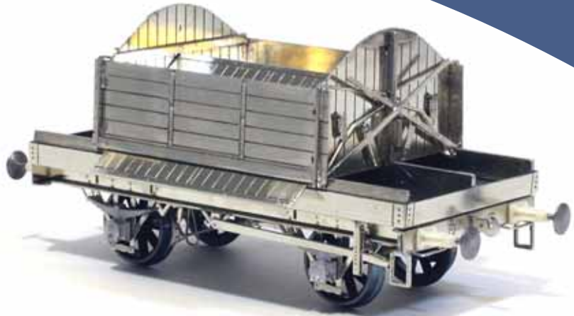
Wäinö Rankan soravaunu on toteuttu syövyttämällä uushopealevystä.
