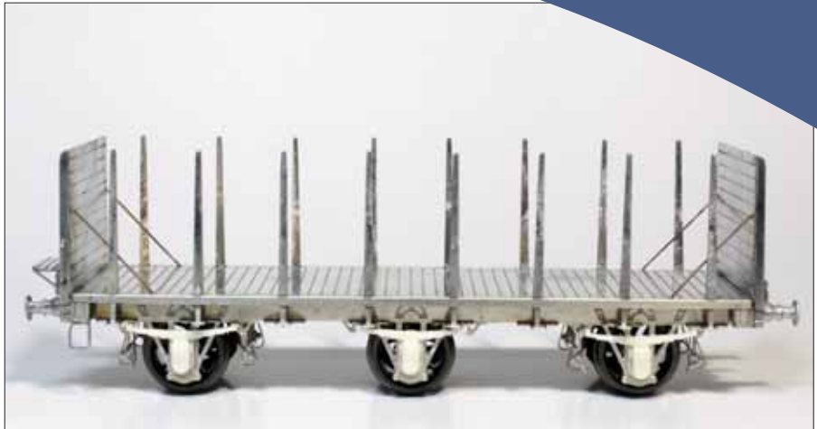
K-sarjan vaunut on helppo rakentaa. Keskimmaisessä pyöräkerrassa on lotinaa, jotta vaunu selviää vähän epätasaisemmalta radalta kunnialla.
