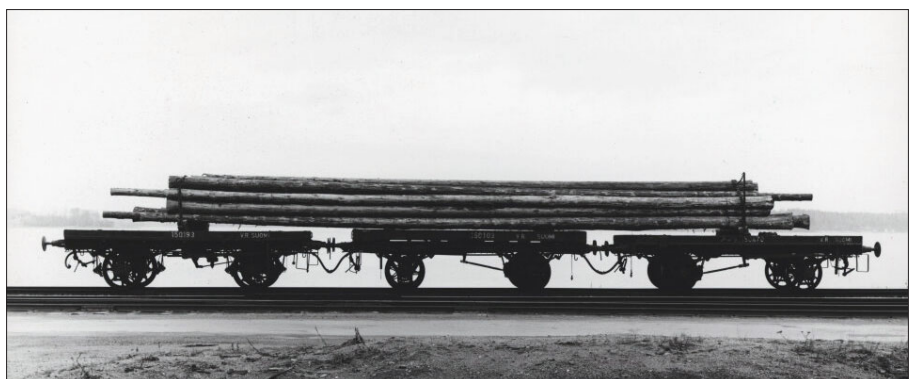
Onko kolmen vaunun lastiksi päätynyt puhelinpylväitä tai sähköverkon ilmajohtopylväitä? Tällaisessa kuormauksessa keskimmäisen vaunun kuormaustuki poistetaan.
