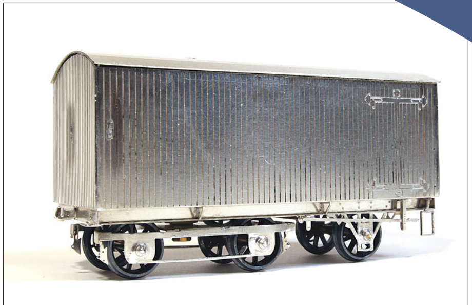
Malli on syvöytetty uushopealevystä. Vaunusta puuttuvat vielä puskimet, telisivut ja laakeripoksit. Ne ovat valuosia.
