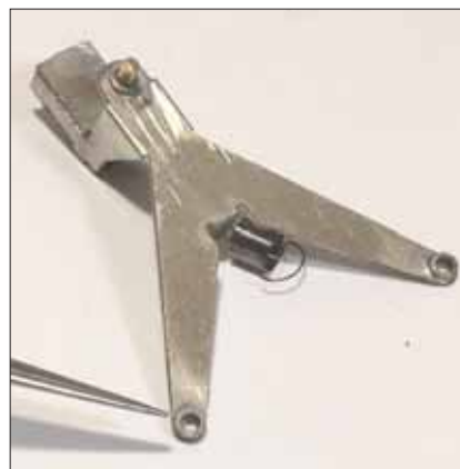
Mekanismin sakaroiden päihin ja johtotappiin ympärille on juotettu prikat.
