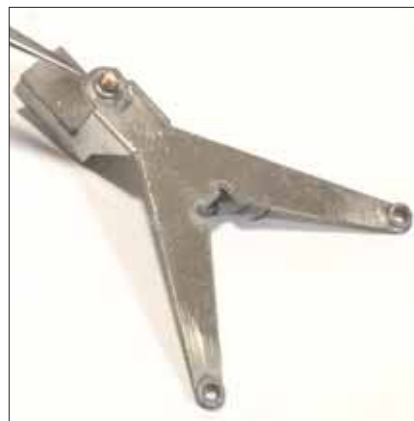
Johtotappi liikkuu vaunun lattiaan syövytyssä urassa.
