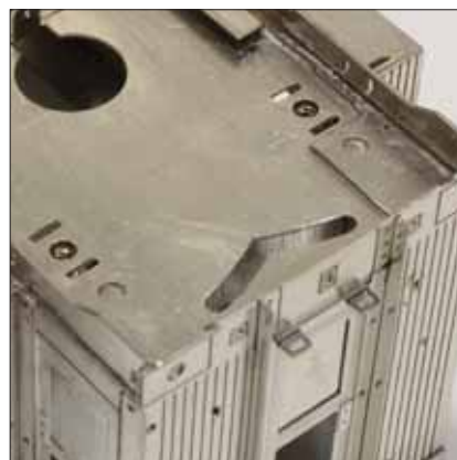
Johtotappi liikkuu vaunun lattiaan syövytyssä urassa.
