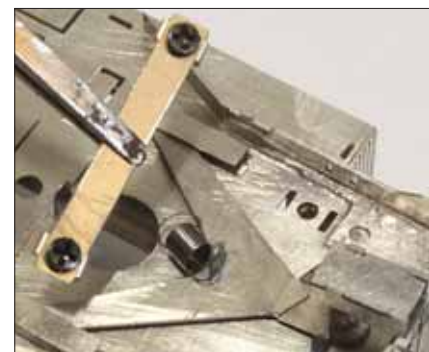
Ruuveilla irrotettava poikittaistuki pitää mekanismin varren oikealla korkeudella.
