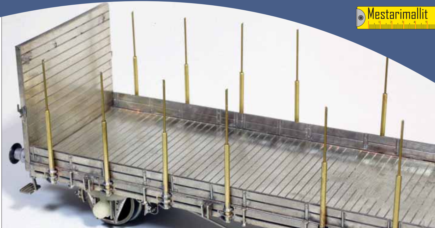
Sivulaidat voi jättää kiinnittämättä. Tukeilla kuormatussa vaunussa sivulaitoja ei käytetty.
