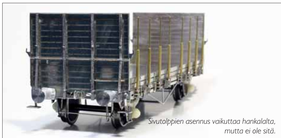
Sivulaidat voi jättää kiinnittämättä. Tukeilla kuormatussa vaunussa sivulaitoja ei käytetty.
